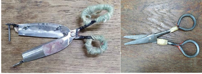
Şekil 7. El halısı dokumada kullanılan makaslar.
