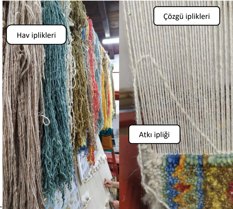
Şekil 5. Halı tezgahında hav iplikleri, çözgü iplikleri ve atkı ipliği.
