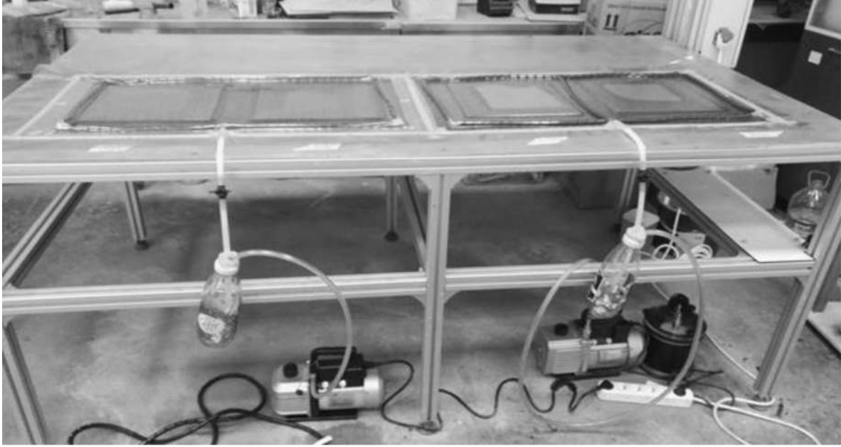
Şekil 1. Al/12 KETP/Al istifinin üretimi ve kullanılan malzemeler
