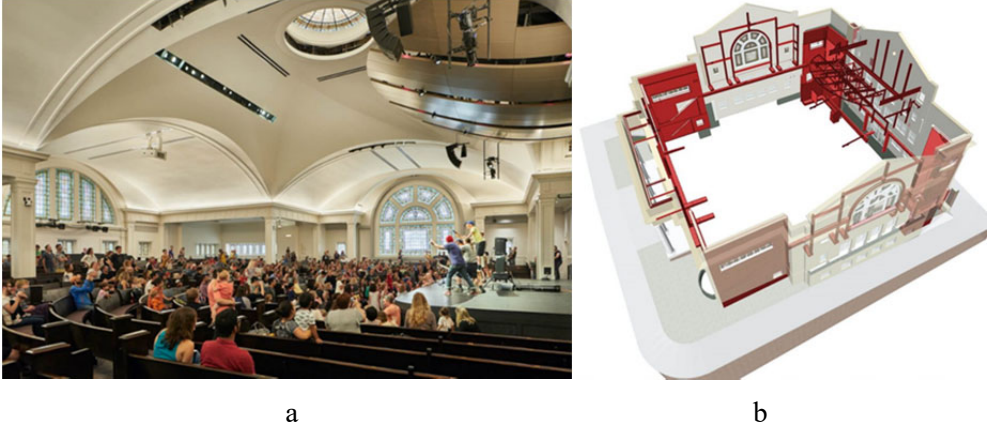
Şekil 4. Tiyatro salonu iç mekanı (a) (Fotoğraf, Ben Benschneider), sismik çelik çerçeve (b) (Buildingwork, 2020).
