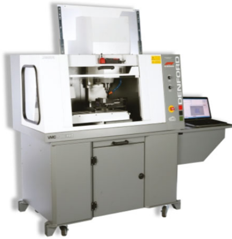
Şekil 2. İşleme operasyonlarının gerçekleştirildiği Denford VMC 1300 model CNC freze
