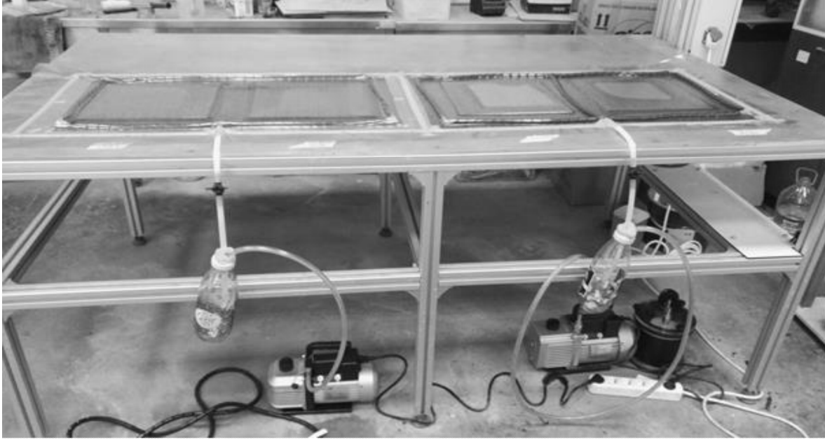
Şekil 1. Al/12 KETP/Al istifinin üretimi ve kullanılan malzemeler
